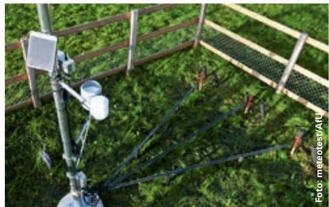
Mast mit Solarpanel, Regen-, Temperatur- und Luftfeuchtemesser sowie Datalogger und Übertragungseinheit. Vom Mast weg führen in drei Schienen die Kabel zu den sechs Tensiometern. Am Ende jeder Schiene misst ein Tensiometer in 20 und 35 Zentimetern Bodentiefe die Bodenfeuchte.
