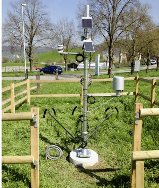
Eine Bodenmonitoringstation wie hier auf Liebegg in Gränichen AG erfasst Niederschlag auf 1,5 m Höhe, Lufttemperatur in 2 m Höhe, Luftfeuchte in 2 m Höhe, Saugspannung in 20 und 35 cm Tiefe sowie Bodentemperatur in 20 und 35 cm Tiefe.
