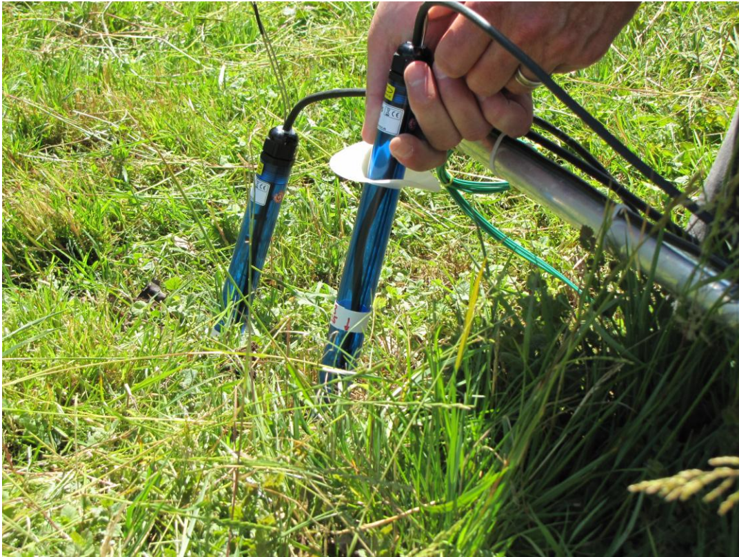
Einbau der Tensiometer in einem 5°-Winkel
