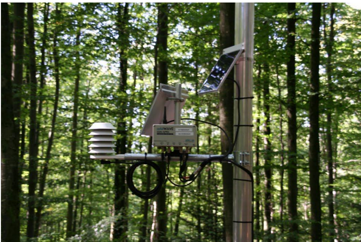
Vaisala-Sonde, GPRS-Sender und Solar-Panels
