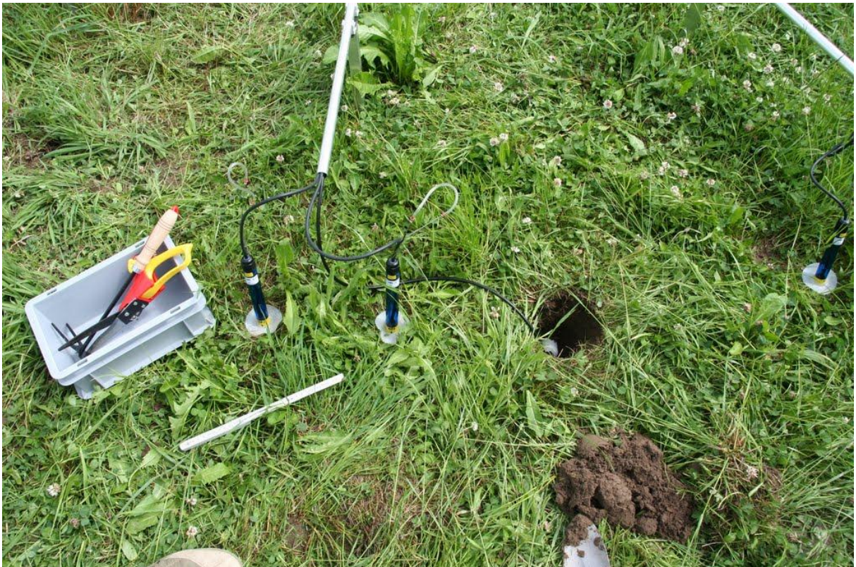
Eingebaute Tensiometer und Einbau der Stevens-Sonde zur Messung
