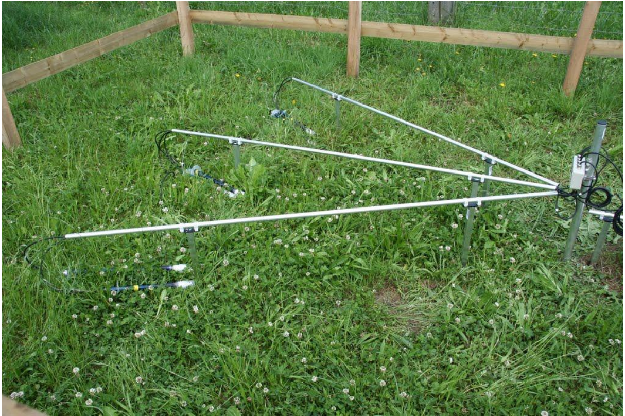
Tensiometer vor dem Einbau
